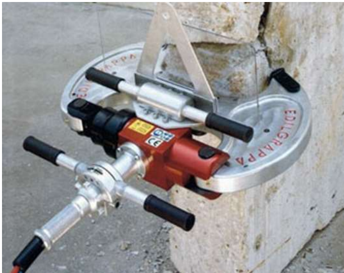
EG-CC-315-DM-T30 Die mitgelieferten kurzen Spitzen fahren bis auf 205 mm zusammen. Unter Verwendung der langen Spitzen schließt die Zange. (Extra bestellen)
